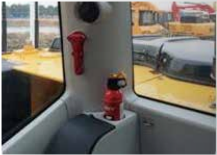
安全锤、灭火器及逃生通道
